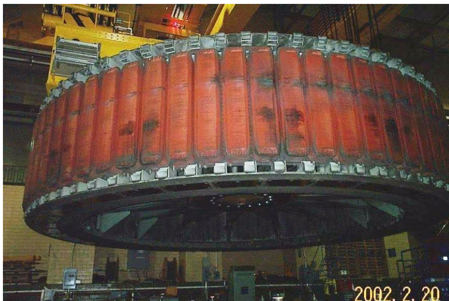
Függőleges tengelyű kiálló pólusú hidrogenerátor forgórésze
