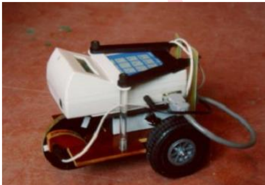
Field Star 1000 mágneses térképező “fiáker”
