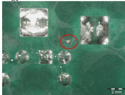
Visszamaradó szennyeződések; forrasztószer és folyasztószer maradvány
