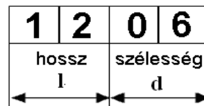
2. ábra. Chip ellenállás méretkódjának értelmezése
