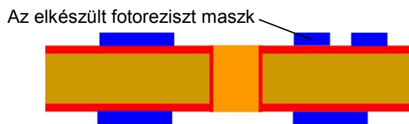
4. ábra. Hordozó az előhívás után (negatív maszk)
