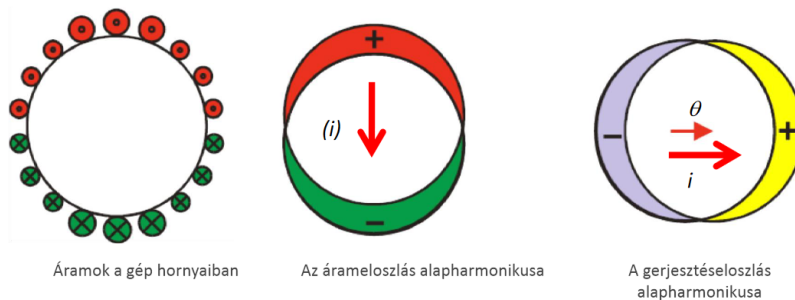
2.3. ábra. Egy tekercs/fázis - a szinuszos áram- és gerjesztéseloszlás térvektora. A gerjesztés és az áram szoros kapcsolatban van; gerjesztési törvény
