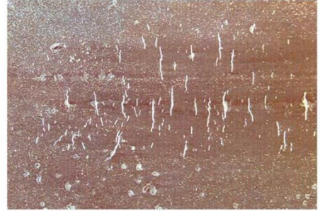
Feszültségkorróziós repedések hegesztési varrat környezetében Szénacél, 15 év üzemi idő, gáztalanító
