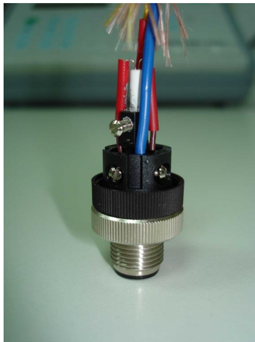
Hidegpont a csatlakozóban
