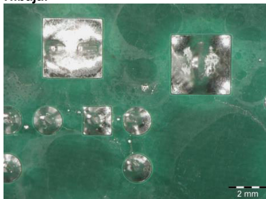
Visszamaradó szennyeződések; forrasztó és folyasztószer maradvány
