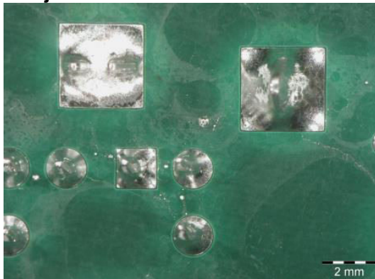
Visszamaradó szennyeződések; forrasztó és folyasztószer maradvány
