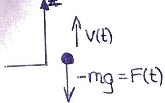
$$\dot{\underline{x}} = \begin{bmatrix} \dot{z} \\ \dot{v} \end{bmatrix} = \begin{bmatrix} 0 & 1 \\ 0 & 0 \end{bmatrix} \begin{bmatrix} z \\ v \end{bmatrix} + \begin{bmatrix} 0 \\ 1/m \end{bmatrix} F(t) = \\ = \begin{bmatrix} 0 & 1 \\ 0 & 0 \end{bmatrix} \begin{bmatrix} z \\ v \end{bmatrix} + \begin{bmatrix} 0 \\ 1/m \end{bmatrix} (-mg)$$
