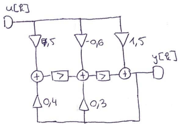
$$H(z) = \frac{1,5 - 0,6z^{-1} + 7,5z^{-2}}{1 - 0,3z^{-1} - 0,4z^{-2}} = \frac{1,5z^2 - 0,6z + 7,5}{z^2 - 0,3z - 0,4} = \frac{1,5z^2 - 0,6z + 7,5}{(z - 0,8)(z + 0,5)}$$
