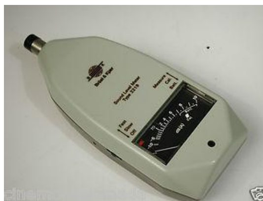
2. ábra: B&K 2219 analóg zajszintmérő.
