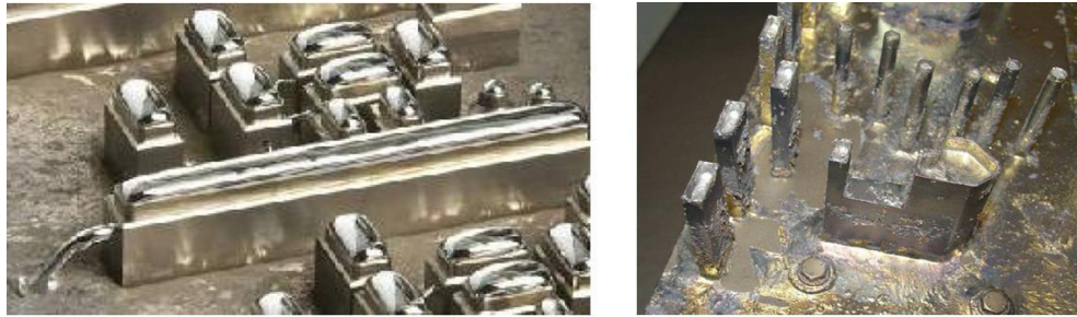
23. ábra. Bélyeges szerszám szelektív hullámforrasztáshoz
