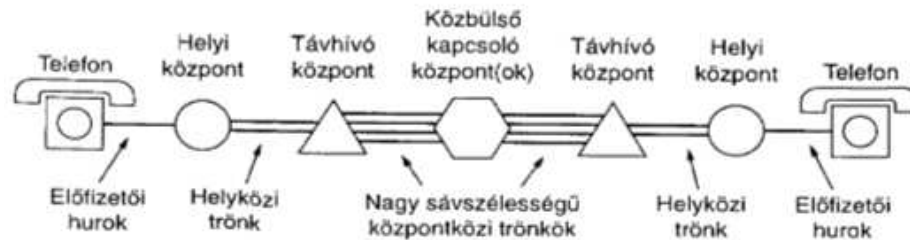
1.18. ábra. Tipikus áramkörti út egy közepes távolságú hívás esetén
