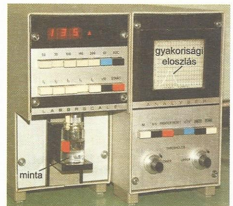
6. ábra. A LABORSCALE és a 64 csatornás impulzusamplitúdó-analizátor lehetővé teszi az alakoselemek méret szerinti eloszlásának vizsgálatát.
