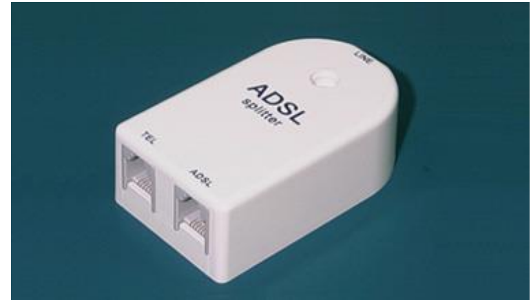
ADSL splitter (váltósűrő)
