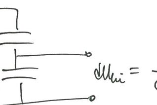
$$U_{hi} = \frac{C_1}{C_1 + C_2} U_{be} \quad \text{Uvei, hosszú hosszú}$$
