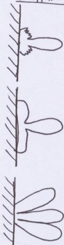
$$p = \underbrace{\frac{\sqrt{2}A}{r} e^{-j(\omega t - kr)}}_{\text{amplitúdő tag}} \cdot \underbrace{n \left[ \frac{\sin(n \cdot k \frac{d}{2} \sin\alpha)}{n \cdot \sin(k \cdot \frac{d}{2} \sin\alpha)} \right]}_{\text{"indifigáló" tag}}$$
