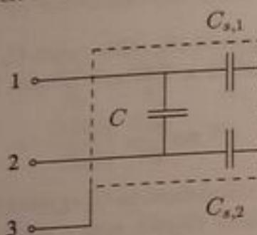
ahol  $C$  a mérődő kapacitás,  $C_{s,1}$  és  $C_{s,2}$  pedig a szort kapacitások.
