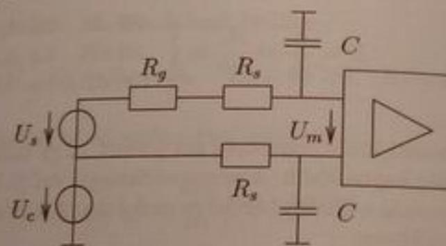
Az előerősítő kimentén megjelenő hasznos, szimmetrikus jelet jelöli  $U_s$ , a közös jelet pedig  $U_c$ . Itt az előerősítő generátor, amelynek kimeneti impedanciáját  $R_g$  jelöli. A második erősítő bemenetén megjelenő jel  $U_m$ .
