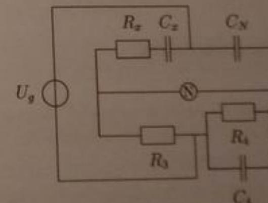
Az ábrán látható ún. Schering-híd kondenzátorok soros helyettesítőképét ( $C_x$ ,  $R_x$ ) méri. Az állítható elemek  $R_3$  és  $C_4$ ,  $R_4 = 10 \text{ k}\Omega$ ,  $C_N = 10 \text{ nF}$ .
