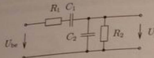
A fenti ábrán az ún. fél Wien-híd kapcsolási rajzát látjuk. A hidat két, egymás-sal elvileg megegyező ellenállás, illetve kondenzátor alkotja, itt az ellenállások névleges értéke  $R = 22 \text{ k}\Omega$ , a kondenzátorok névleges értéke  $C = 6.8 \text{ nF}$ . A hid rezonanciafrekvenciája az a frekvencia, ahol a bemenet és a kimenet közötti fázistolás zérus.
