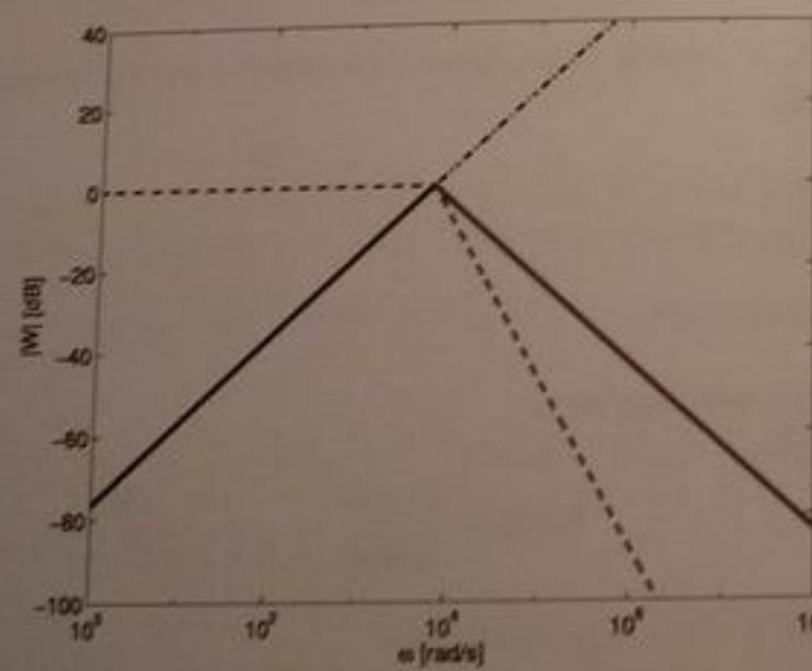
A pontozott vonal a számláló amplitúdómenete, a szaggatott a nevező.
