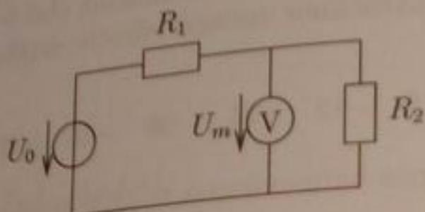
Határozzuk meg  $U_0$  értékét a fenti kapcsolásban a legkedvezőtlenebb esetben előforduló hibájával együtt! A kapcsolásban  $R_1 = R_2 = 1 \text{ k}\Omega \pm 1\%$ .  $U_m$ -et digitális voltmérővel mérjük, amelynek a mért értékre vonatkoztatott hibája 0.02%, a végkitérésre vonatkoztatott hibája 0.01%, a mért érték 1 V, a méréshatár 20 V.
