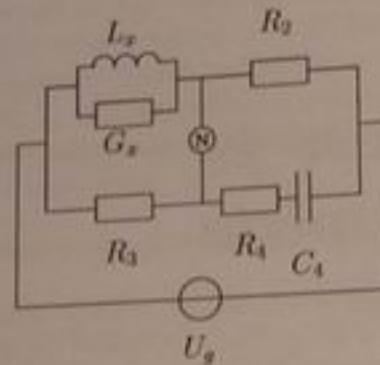
Az ábrán látható ún. Hay-híd induktivitás párhuzamos helyettesítőképét ( $L_x$ ,  $G_x$ ) méri. Az állítható elemek  $R_4$  és  $C_4$ ,  $R_2 = R_3 = 1 \text{ k}\Omega$ .
