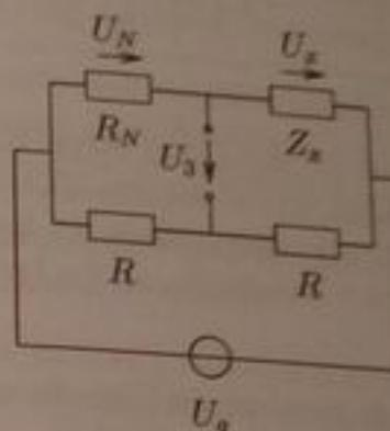
Az ábrán látható ún. Grützmacher-híd impedanciamérésre alkalmas. A mérés úgy történik, hogy az  $R_N$  ellenállást addig állítjuk, amíg a rajta eső  $U_N$  feszültség abszolút értéke nem egyezik meg a  $Z_x$  impedancián eső  $U_x$  feszültség abszolút értékével. A jelen összeállításban  $R = 4.7 \text{ k}\Omega$ , és egy veszteséges kondenzátor mérünk,  $f = 318.3 \text{ Hz}$  frekvencián.
