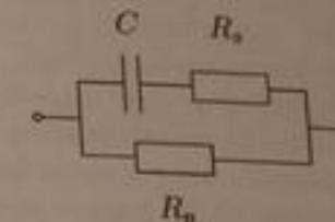
A kapacitás a példában megadott érték:  $C = 100 \text{ nF}$ . A megadott adatok alapján a kondenzátor veszteségeiben a kisebb frekvencián a párhuzamos vezetés, a nagyobb frekvencián a soros ellenállás dominál, így a két veszteségi tényezőt külön-külön az ábrán látható két ágra felírva:
