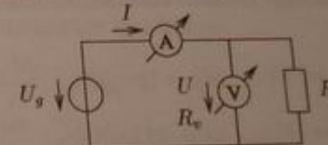
Ilyenkor ugyanis az ampermérő nemcsak a fogyasztón, hanem a voltmérő belső ellenállásán folyó áramot is méri. A mért és a fogyasztón valóban disszipálódó teljesítmény:
