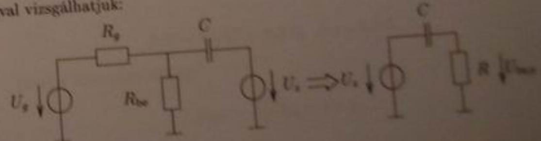
Az ábrán  $R = R_g \times R_{be} = 500 \text{ k}\Omega$ . Ekkor a kérdéses zavarfeszültség:
