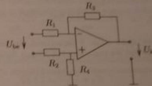
Természetesen az  $R_1 - R_3$  és  $R_2 - R_4$  párok felcserélésevel is helyes megoldáshoz jutunk.
