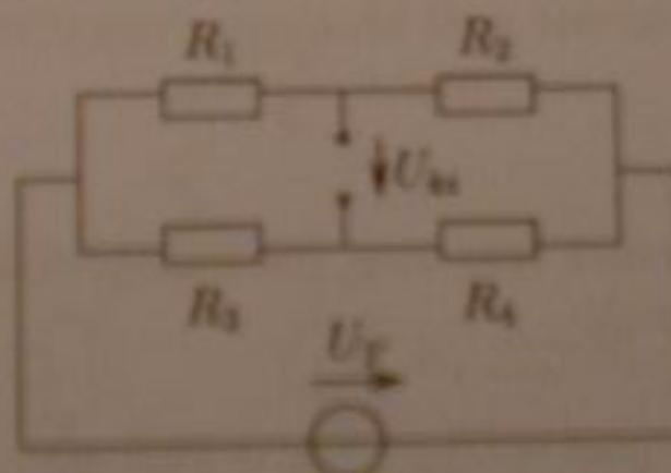
Rendszerint a hálókapcsolás ellenállásai egyenlő névleges értékük. A kapcsolás viselkedése különösen szerint, hogy hány érzékelő elem van a hidban, azok változása milyen előjelű, illetve a táplálás feszültség-vagy áramgenerátoros. Néhány esetet az alábbiakban tekintünk át.
