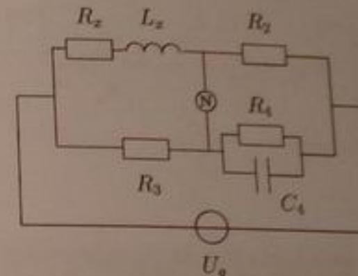
Az ábrán látható ún. Maxwell-Wien-híd induktivitás soros helyettesítőképét ( $L_x$ ,  $R_x$ ) méri. Az állítható elemek  $R_4$  és  $C_4$ ,  $R_2 = R_3 = 100 \Omega$ .
