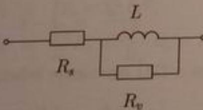
ahol  $R_s$  a rézveszteséget,  $R_v$  pedig a vasveszteséget reprezentálja,  $L$  az induktivitás. A soros ohmmérővel egyenáramú mérést végezünk, így a példában megadott  $R_s$  közvetlenül a rézveszteséget adja:
