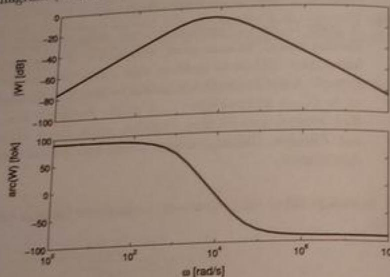
A számítógépes programmal történő ábrázolásnál tamulságosabb az amplitúdókarakterisztika aszimptotáinak felrajzolása. A Bode-diagram ilyen módon történő szerkesztésének ismerete nem is az analízis, mint inkább a szintézis szempontjából lényeges. Az amplitúdókarakterisztika aszimptotikus diagramja tehát az alábbi ábrán látható:
