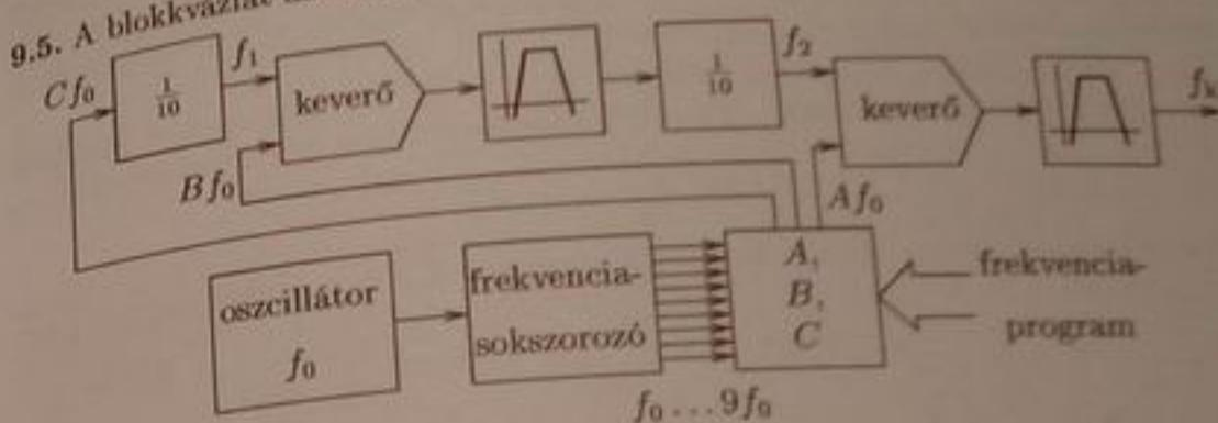
A szorzók kimenetén az összeg- és a különbségi frekvenciák jelennek meg. A sávszűrők specifikációja olyan, hogy az összegfrekvenciát engedik át. Az ábrán feltüntetett frekvenciák az alábbiak:
