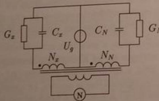
Az ábrán látható áramkomparátoros híd kapacitás párhuzamos helyettesítőképét ( $C_x$ ,  $G_x$ ) méri. Az állítható elemek  $N_N$  és  $G_N$ ,  $N_x = 1000$  és  $C_N = 100 \text{ nF}$ .
