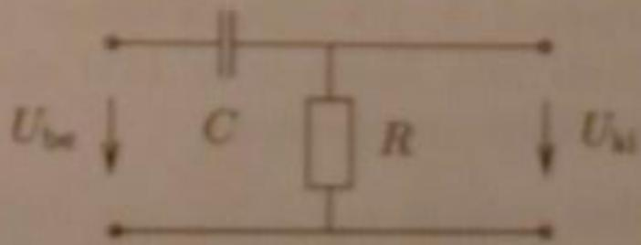
Egy  $RC$ -tagot a fenti ábrának megfelelően felüláteresítő szűrőnek használunk. A szűrő kimenetén megjelenő jel amplitúdója kisebb, mint a bemeneti jelé, ez rendszeres hibát jelent. Mekkora a relatív rendszeres hiba, ha a mérődő színeses feszültség frekvenciája  $500 \text{ Hz}$ , az  $RC$ -tag törésponti frekvenciája pedig  $20 \text{ Hz}$ ?
