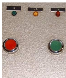
6. ábra: az egyfázisú próbatranszformátor vezérlőpultjának kezelőszervei
