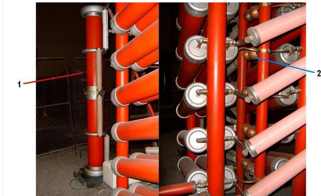
7. ábra: lökésgerjesztő berendezés. 1: kompenzált lökőfeszültség osztó; 2: szikraköz
