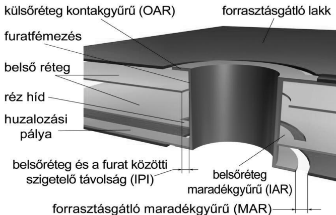
6.2.1. ábra. 4 rétegű szerelőlemez
