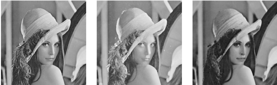
7.3. ábra. Az erózió és dilatació művelete végrehajtható szürkeárnyaltos képeken is. Ekkor dilatació maximum szűrőként (közép) az erózió pedig minimum szűrőként (jobb) viselkedik.
