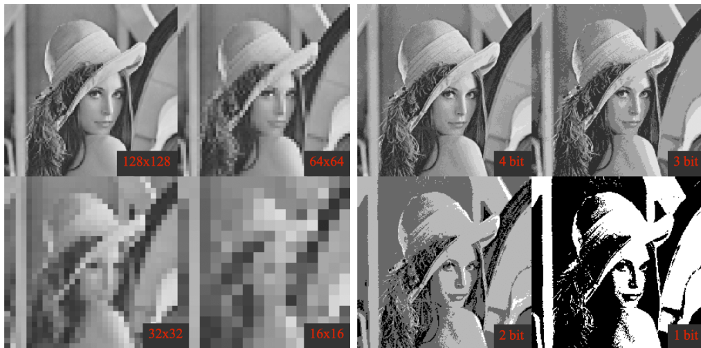
1.11. ábra. A felbontás és a bitmélység csökkentésének hatása.
