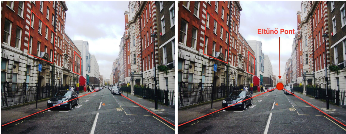
13.1. ábra. A 3D geometriai jellemzők torzulása (bal) és az eltűnő pont (jobb).
