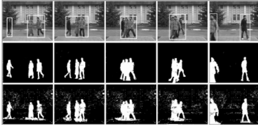
6.15. ábra. A gauss háttérmodell alapú mozgásszegmentálás elve. A középső sorban a variancia alapú különbségküszöbözéssel előállított képek látszanak, míg az alsó sorban az egyszer konstans küszöbvel készített eredmények.
