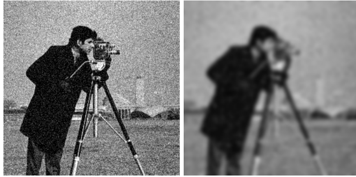
2.8. ábra. Egy fehér zajjal terhelt kép (balra) és a simító szűrés hatása (jobbra).
