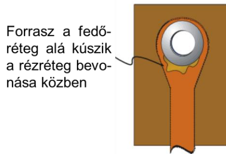
29. ábra. HASL védőfémezés kialakítása során a forrasz a fedőréteg alá kúszik
