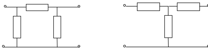
42. ábra \Pi vagy T kétkapú lézer illesztésére
