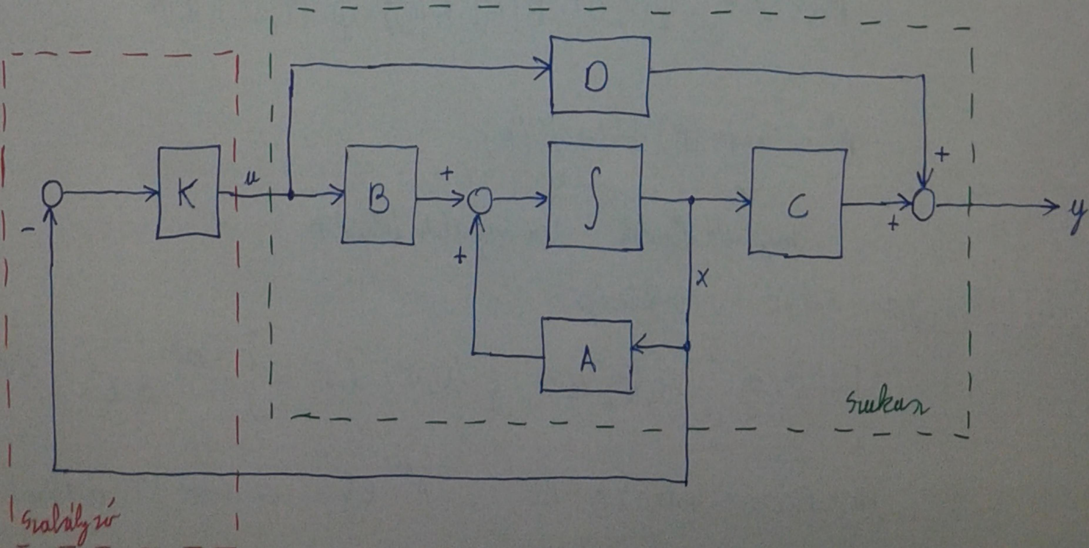
⑤ inánnyíthatósgyűjtemény alak: t<sub>2</sub> LTI rendszerek állapotgyenleteinek van olyan  $\mathbb{R}^n = L + L^\perp$ ,  $x = x_a + x_e$  ( $x_a \in L$  és  $x_e \in L^\perp$ ) fellontása, amelyben az állapotgyenlet alakja ígynevezett inánnyíthatósgyűjtemény alakú:
